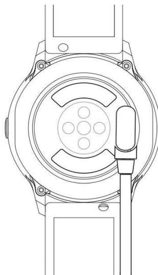
\* Tenga en cuenta que los dos contactos del cable USB no pueden entrar en contacto con el conductor al mismo tiempo, o quemará el circuito
